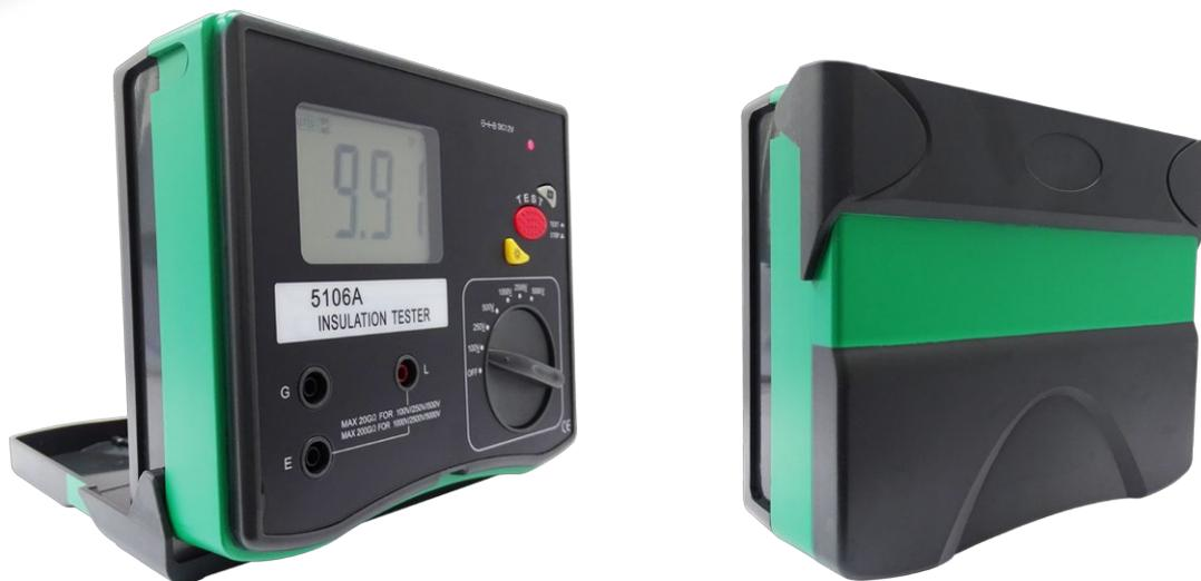
El Giga-ohmetro 5106A es un instrumento destinado a la medición de resistencia de aislación de hasta 200GΩ con tensiones de prueba de hasta 5000V, conforme a la tensión de diseño, nominal y de aislación de componentes, equipos o instalación: conductores, interruptores, motores, etc. En instalaciones industriales, comerciales y residenciales.
